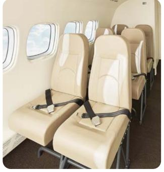
VARIABLE CONFIGURATION WITH 17-19 FOLDABLE SEATS ALLOWS A QUICK CHANGE TO CARGO
